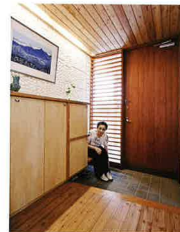
▲既存の狭い玄関を広げに変更。防犯に配慮しながら光を取り入れるガラス窓を。下駄箱に続けてベンチも製作。「腰かけて靴の脱ぎ履きができて助かります」と圭子さん。
